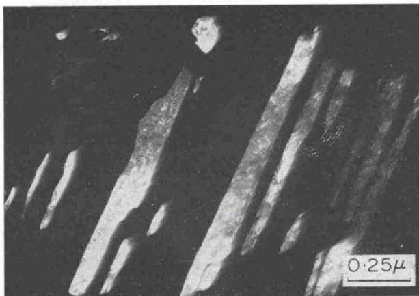
FIG. 5. Mâcles dans l'alliage désordonné choqué.
